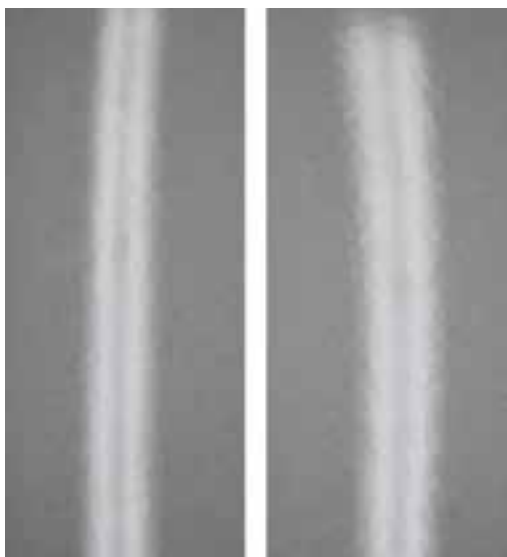
L'image illustre les deux surfaces. L'échantillon de gauche a reçu le revêtement Ultragal®. Sur le panneau de droite (traité Extragal®), l'ondulation est attestée par la déformation de la réflexion du néon.
