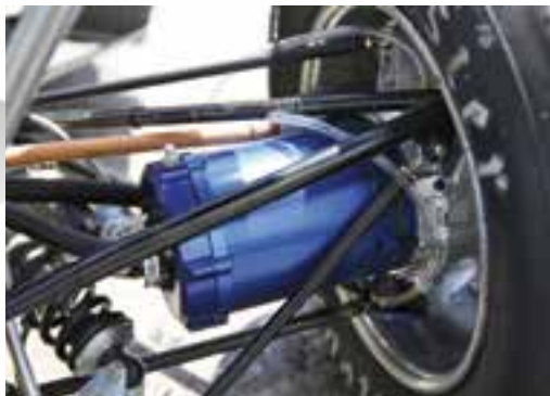
Chaque roue est entraînée par un moteur électrique indépendant à base d'acier iCARE® Save.
